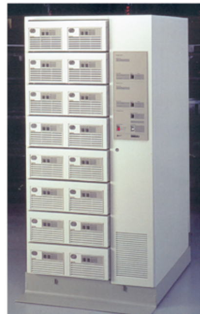
IBM 9394 RAMAC Subsystem mit integrierter Steuereinheit. Breit 75 cm, tief 98 cm, hoch 158 cm, Gewicht 754 kg
