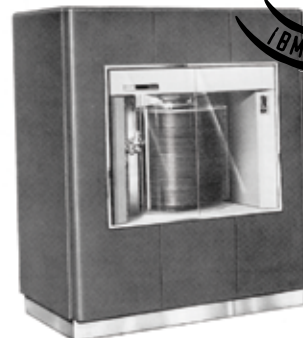
Die Magnetplattenspeichereinheit IBM 355, 158 cm breit, 77 cm tief und 181 cm hoch; Gewicht 947 kg.
