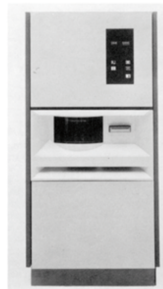
Bild oben: Magnetplatteneinheit 5445 mit Schublade für den Standard- Wechselplattenplattenstapel 2516 (in der Mitte).
