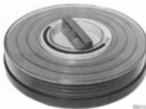
Plattenstapel Typ IBM 1316 mit 10 Speicheroberflächen.
