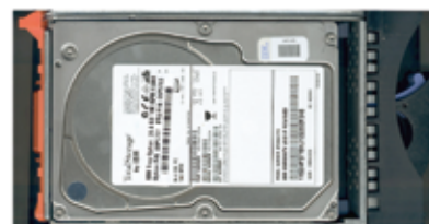
Ein Laufwerk von 2003 mit 36 GB Speicherkapazität. Links elektrische Steckverbindungen, rechts der snap-in Mechanismus für einfache Auswechslung durch den Operator. 21,3cm breit, 12,2 hoch, 2,8 cm tief
