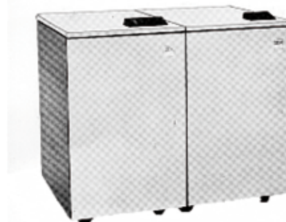
Zwei Einheiten 3310, eine davon als Haupteinheit, die zweite als „Sklave“.
