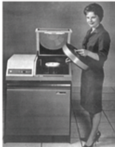
Plattenspeichereinheit IBM 1311 mit geöffneter Abdeckung zur Auswechslung des Plattenstapels.
