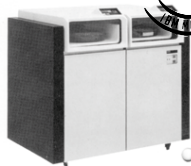
2 Einheiten IBM 3340, rechts die Kopfeinheit mit eingebauter Steuereinheit Quelle: DPCE Prod. Folder IBM 3340
