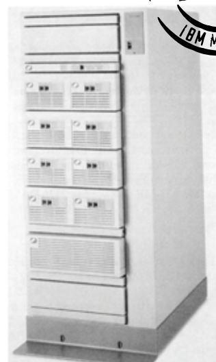
Subsystem 8 Einschüben 9345 und darunter die Steuereinheit Modell 9341 , alles im Rahmen 9309 . Maße/Gewicht: breit: 65 cm, tief: 94 cm, hoch: 158 cm, Gewicht 800 kg
